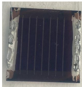
Abb.3 Perowskit-Minimodul: Vorderseite (links), Rückseite (rechts).
