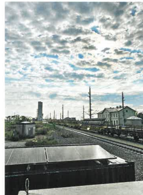
Links: Der Demonstrator zur autarken Energieversorgung einer Eisenbahnkreuzungs-Sicherungsanlage wurde in einen 20-Fuss-Container verbaut, in dem für die Versuchsreihe auch die Antriebe der Schrankenanlage untergebracht waren (Foto: Reneron).
