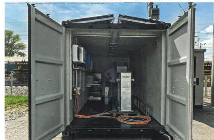
Links: Der Demonstrator zur autarken Energieversorgung einer Eisenbahnkreuzungs-Sicherungsanlage wurde in einen 20-Fuss-Container verbaut, in dem für die Versuchsreihe auch die Antriebe der Schrankenanlage untergebracht waren (Foto: Reneron).
